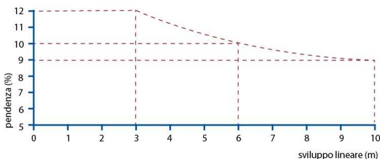
In linea generale sia per le rampe o scivoli di raccordo su percorsi pedonali che nel caso di rampe di accesso ad edifici o simili, al fine di favorire l'autonomia nella fruizione, si considera ottimale garantire pendenze non superiori al 5%.
